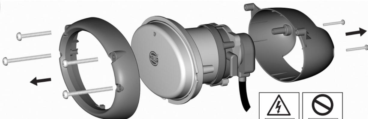
Aufbauscheinwerfer mit integriertem Vorschaltgerät öffnen
